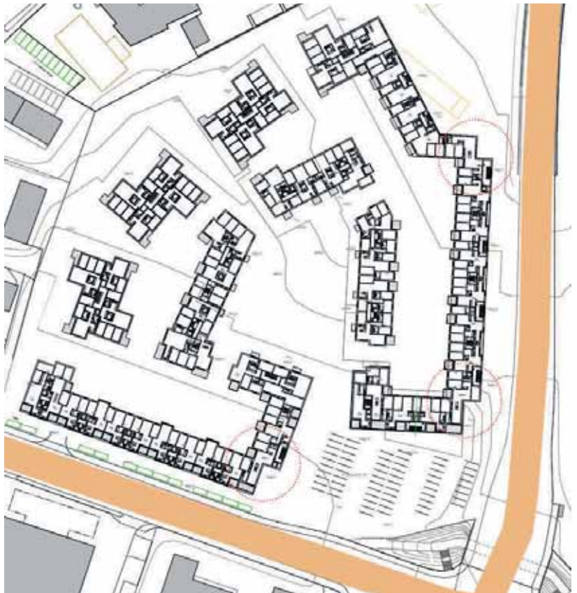
Eine lärmoptimierte Stellung der Gebäude und schmale Baukörper für durchgehende Räume sind primäre Massnahmen für neue Wohnbauten im Lärm. Quelle: Fachstelle Lärmschutz
