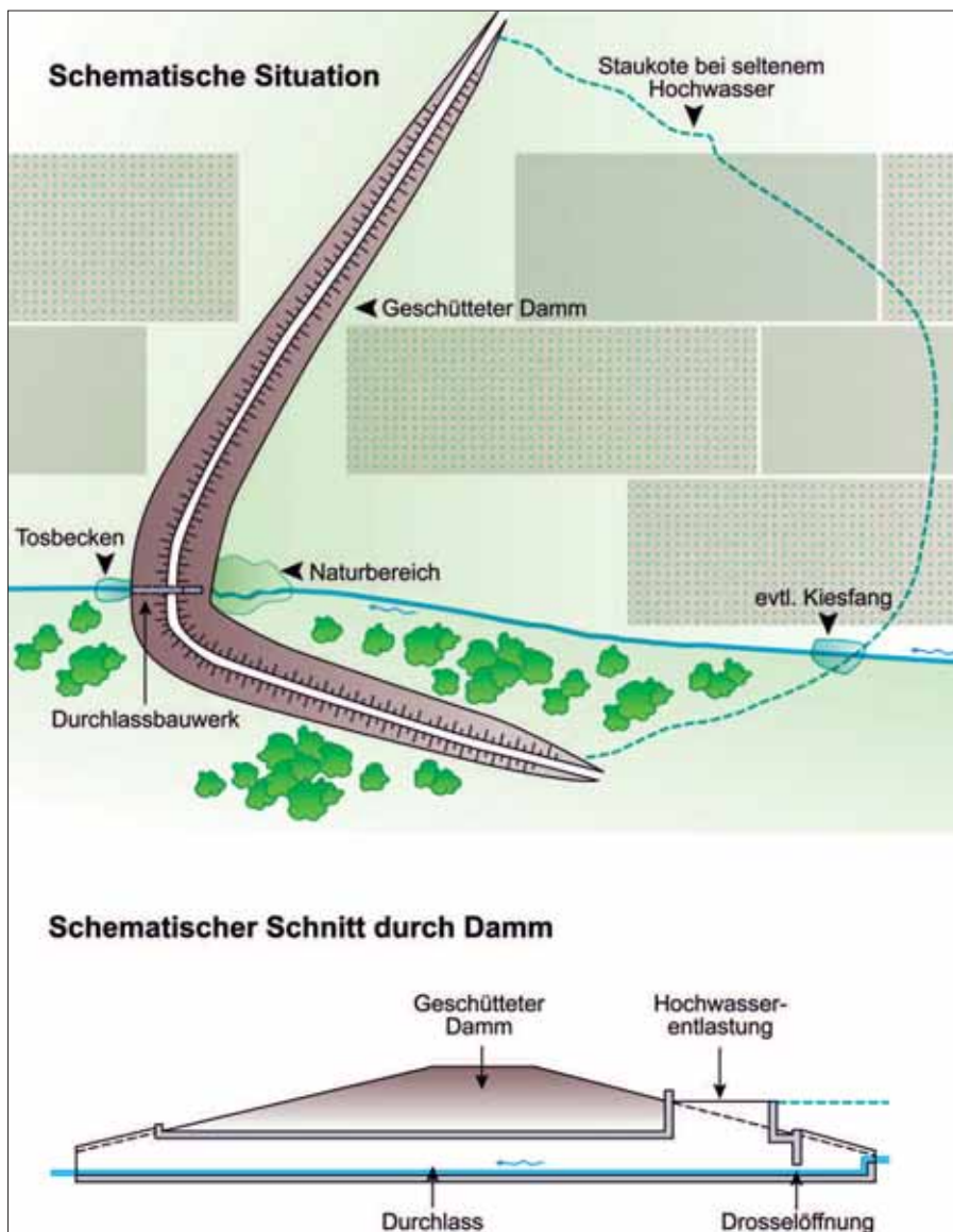
Ein typisches Hochwasserrückhaltebecken: Situation und Schnitt.
