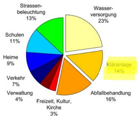
Abbildung 1-1: Stromverbrauch von kommunalen Gebäuden und Anlagen: Hochrechnung EnergieSchweiz für Infrastrukturanlagen (1)
