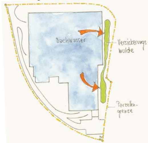
Ein gutes Beispiel für das Ausnutzen von Randzonen sind die Versickerungsmulden beim Industriebau der Prodega in Dietikon.
