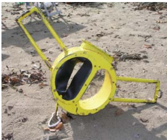
Abb. 2: Spezialgerät der Firma Hydra (Konstanz) für Probenahmen in grossen Fliessgewässern durch einen Taucher. Der Netzbeutel ist in der Abbildung nicht zu sehen.
