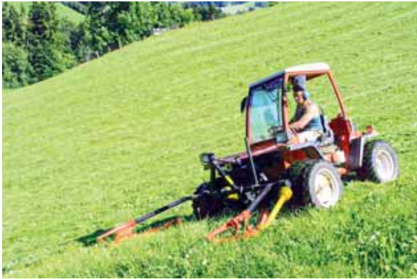
Wie gemäht wird, hat einen grossen Einfluss auf die Bienenpopulation (im Bild: Doppelmesserbalken). Quelle: ART, Tänikon / AGRIDEA
