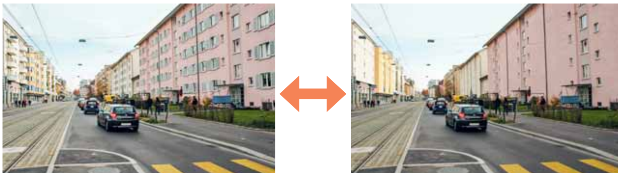
Die Simulation zeigt: Vollständig lärmabgewandt ausgerichtete Gebäude führen zu toten Strassenräumen. Die Attraktivität und das Sicherheitsgefühl der Fussgänger leiden. Guter Lärmschutz sorgt für beides: attraktiven Wohnraum und städtebaulich hochwertige Lösungen. Quelle: Fachstelle Lärmschutz
