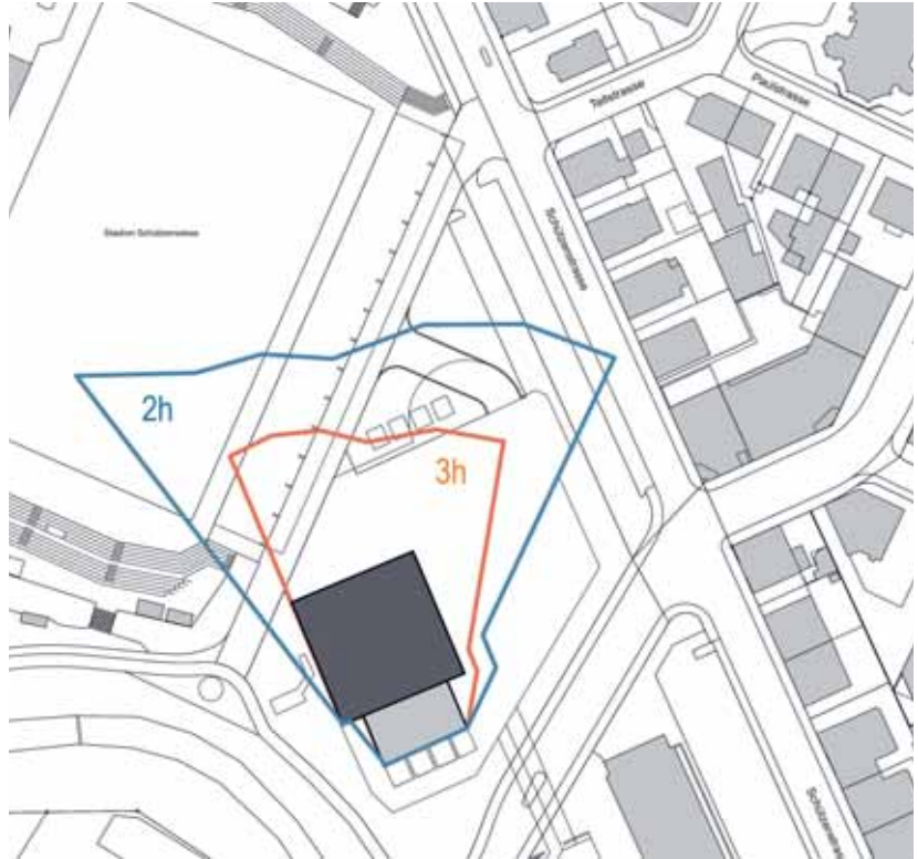
Ob naheliegende Wohngebäude übermässig beschattet werden, wird im Schattendiagramm sichtbar, und die Beschattungsdauer kann berechnet werden. Im Bild dargestellt ist der relevante Schatten bei unterschiedlicher Schattenwurfdauer (2h- bzw. 3h-Regel). Quelle: ARE
