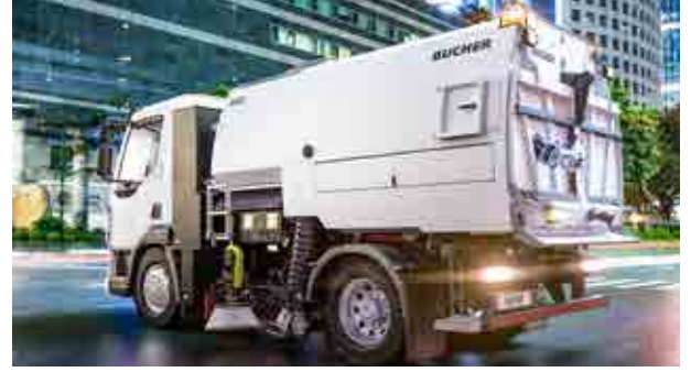
Auch klimaschonende Spezialfahrzeuge sind bereits verfügbar: So hat das Tiefbauamt ein elektrisch betriebenes Grosskehrfahrzeug beschafft. Quelle: Bucher Municipal AG
