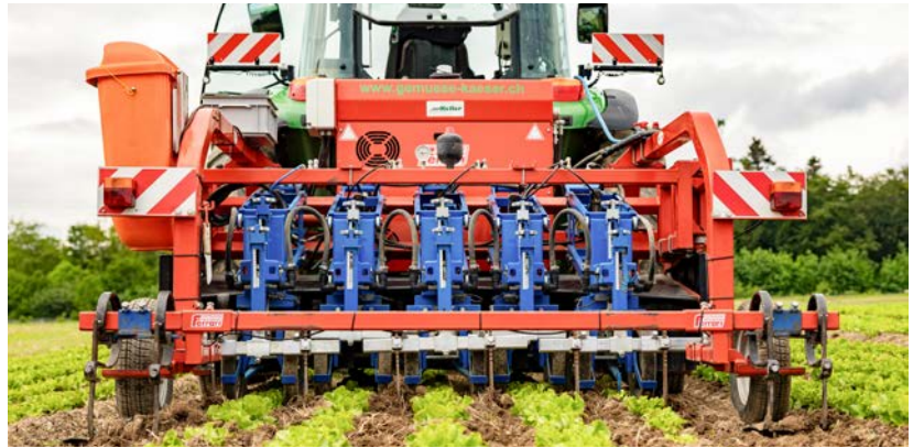
Mit sensorgesteuerten Hackgeräten lässt sich Unkraut mechanisch beseitigen – dadurch kann der Einsatz von Pflanzenschutzmitteln reduziert werden. Quelle: Strickhof
