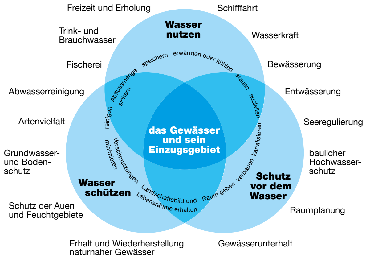
Wechselwirkungen der wasserbezogenen Schutz- und Nutzungsinteressen im System der integralen Wasserwirtschaft. Quelle: Bundesamt für Wasser und Geologie (Hrsg.), «Eintauchen in die Wasserwirtschaft», Bern, 2003
