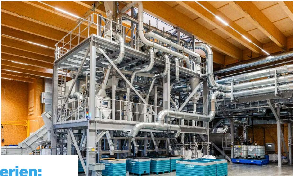
Verarbeitung von Lithium-Ionen Batteriematerialien zur Produktion von Schwarzmasse bei Librec.
