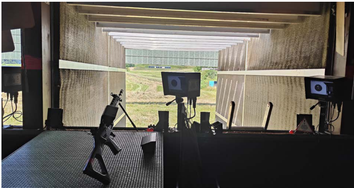
Hier sieht man in der Schiessanlage Erlösen in Wetzikon (Sicht aus Schiessstand) neben der elektronischen Trefferanzeige und einem Sturmgewehr (StgW 90) eine Versuchsanordnung aus dem Jahr 2024 mit Rasterdecke und Lägerblenden. So soll die Wirkung dieser Massnahmenkombination beurteilt werden.
