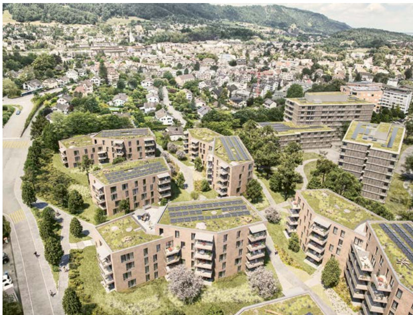
Visualisierung Richtprojekt, Privater Gestaltungsplan Rifertstrasse: Die Wohngebäude sind SNBS-zertifiziert. Geheizt wird mit Wärmepumpen. Die begrünten Flachdächer sind mit Photovoltaikanlagen ausgestattet, die erneuerbaren Strom produzieren. Quelle: www.rifertstrasse.ch/projekt , Swiss Re AG
