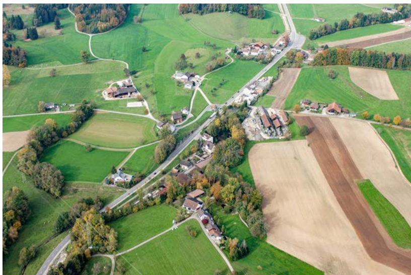
Strassengenerationen in Edikon bei Dürnten. Neben der im 19. Jahrhundert gebauten geraden Linienführung liegt die alte, kurvenreiche Vorgängerin. Quelle: Simon Vogt, KA Zürich, Oktober 2006. KA Zürich, Fotoarchiv.
