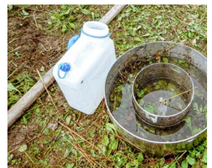
Doppelring-Infiltrometer Quelle: Jäckli Geologie AG
