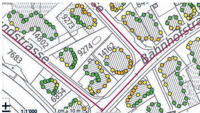
Zukünftige Darstellung des Strassenlärms im GIS-Browser. Zu erkennen ist, wie hoch die Lärmimmissionen an den Fassaden im Vergleich zu den Grenzwerten sind. IGW: Immissionsgrenzwert, PW: Planungswert. Orange markierte Fassaden sind stark lärmexponiert.
