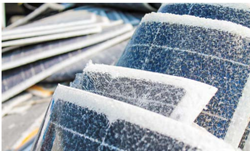
Nach dem ersten Behandlungsschritt des Recyclings liegen die PV Module frei. In nächsten Schritten werden sie noch vom Verkapselungsmaterial und dem Frontglas getrennt.
