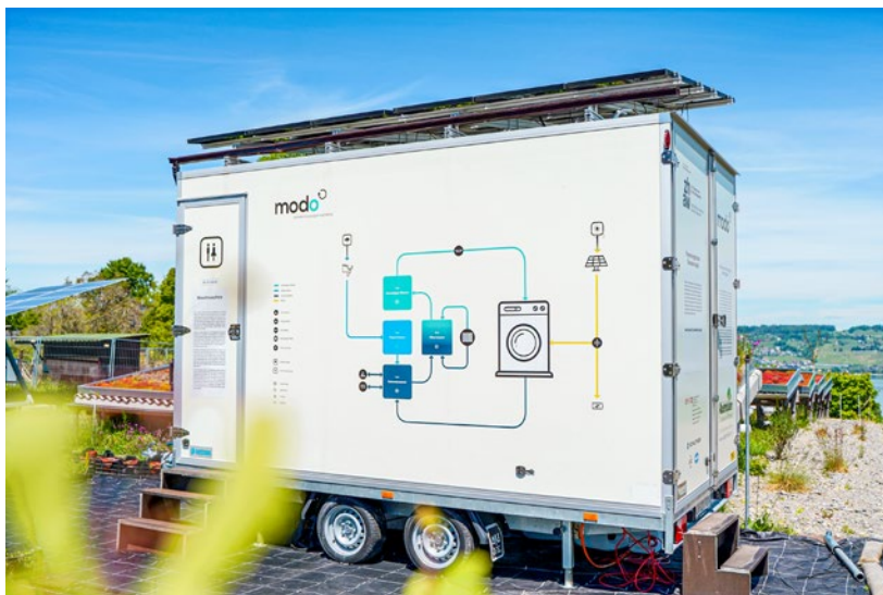
Seitenansicht des LaundReCycle-Prototyps. Als Waschsalon ohne Wasser- oder Stromanschluss funktioniert er ressourcenschonend selbst in abgelegenen Gegenden.
