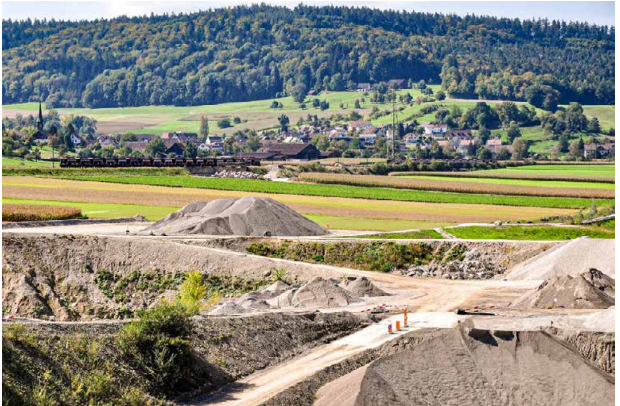
Kies ist eine endliche Ressource. Primärmaterialien wie Kies und Sand sollen geschont werden, indem rezyklierte Materialien wie Ausbauasphalt gemäss Stand der Technik verbaut werden. Quelle: Roland Fischer, WikimediaCommons, CC BY-SA 3.0
