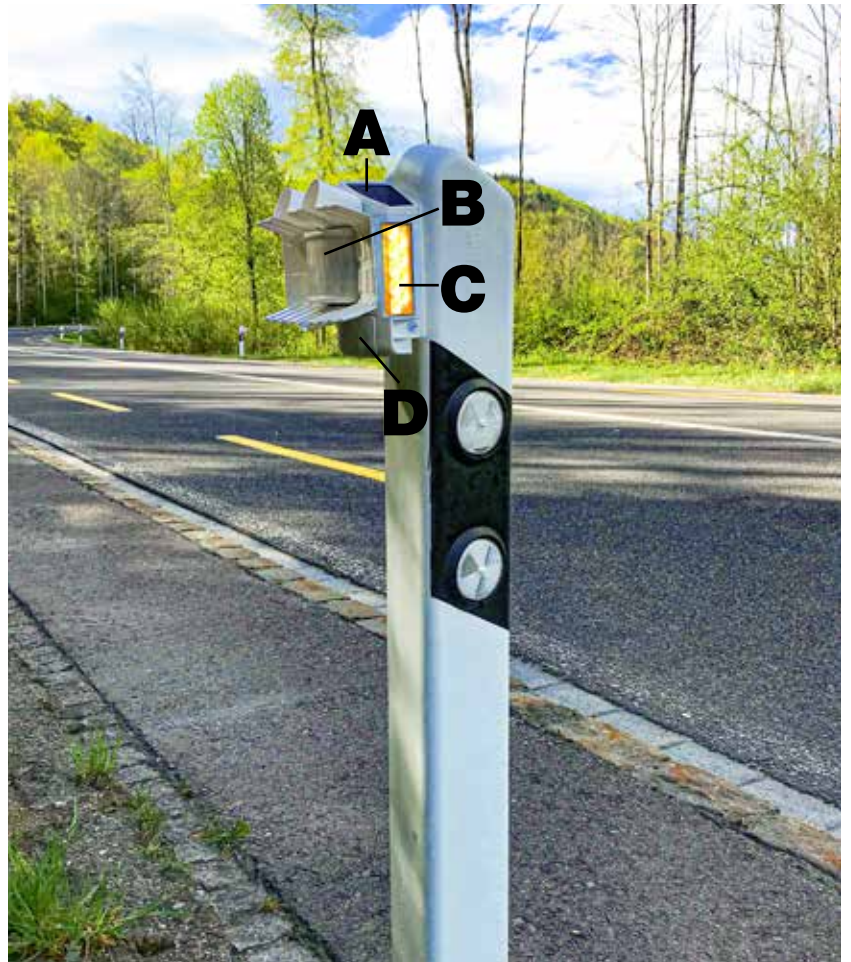
Die Module der Wildwarnanlage werden an die weissen Strassenleitpfosten mit einem maximalen Abstand von 50 Metern montiert. Die Hauptbestandteile eines Moduls sind: A) Solarmodul, B) Erkennungssensor, C) LED-Warnsignal und D) Akkufach und Speicherung der Daten.
