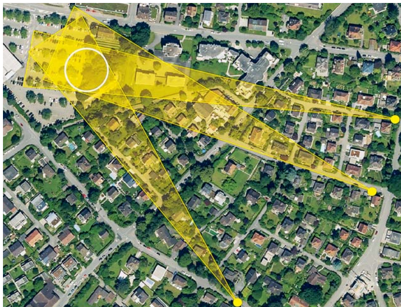
Ortung der Quelle eines Störgeräuschs (im weissen Kreis) von drei verschiedenen Standorten aus. Quelle aller Abbildungen: Leitfaden «Umgang mit leisen Störgeräuschen», Kanton Aargau
