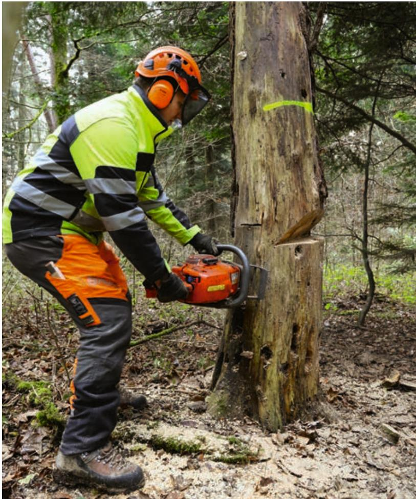
Der «Stechschnitt» darf nur von Profis ausgeführt werden.
