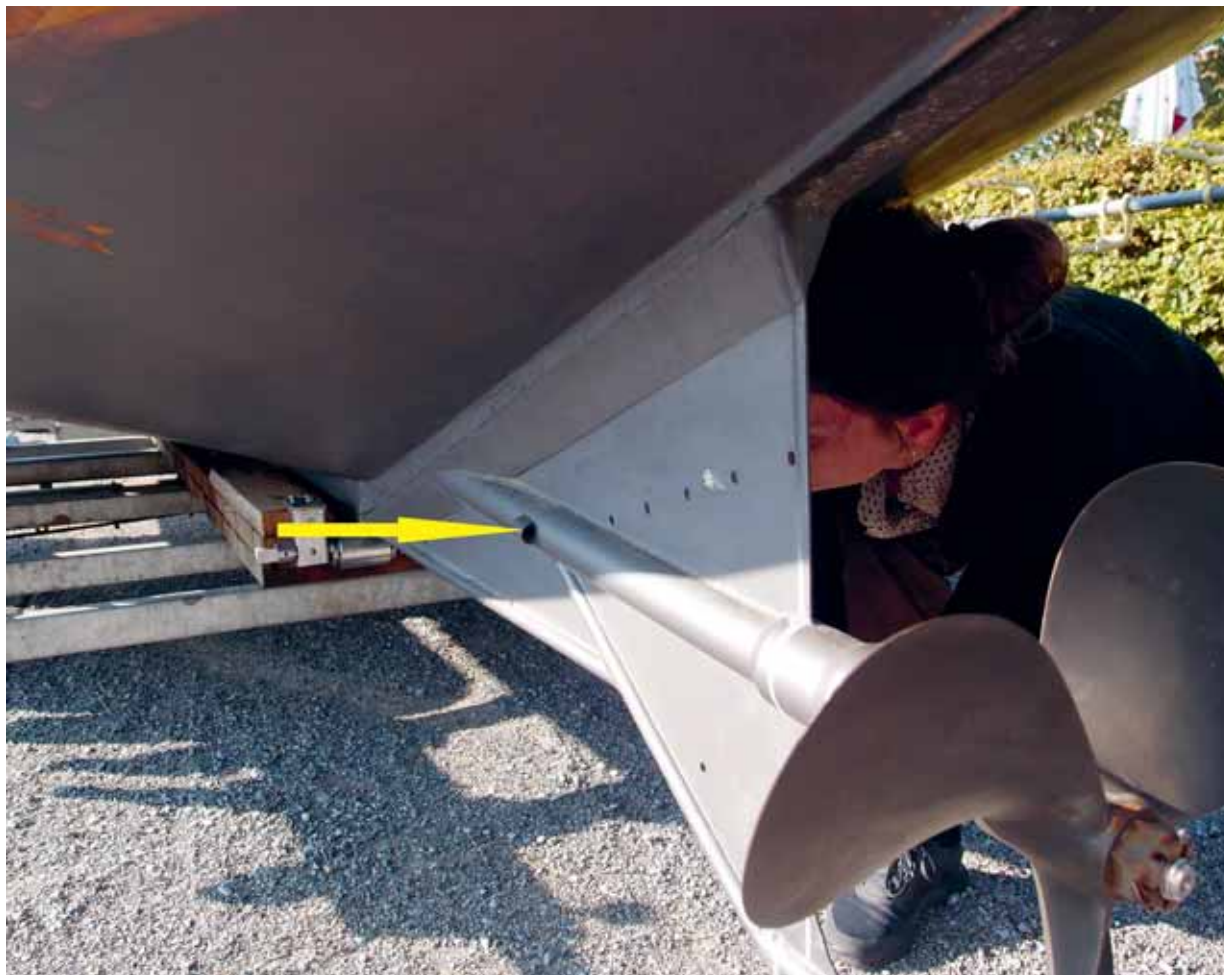
Bei der Probenahme im Rohr zur Schiffsschraube wurden beidseitig mehrere Wandermuscheln ( Dreissena ) gefunden (mit gelbem Pfeil markiert). Quelle: Renato Guidon, AWEL
