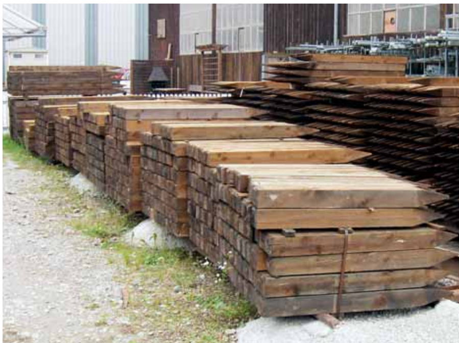
Bei der Beregnung von imprägnierten Holzstapeln wird das Regenwasser mit Holzschutzmitteln verschmutzt. Solche Stapel müssen in Zukunft gedeckt gelagert werden.
