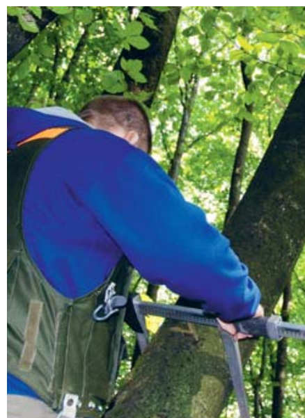
Mit einer so genannten Kluppe wird der Durchmesser aller Probestäume auf 1,3 Meter Höhe gemessen.
