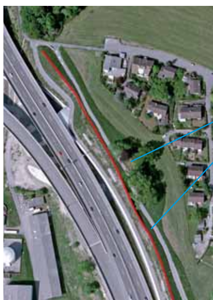
Untersuchungsgebiet beim Autobahndreieck Zürich-Brunau mit Lärmschutzwall und reflektierender Baumgruppe. Die Grafik zeigt die Lärmausbreitung zum Wohngebiet.
