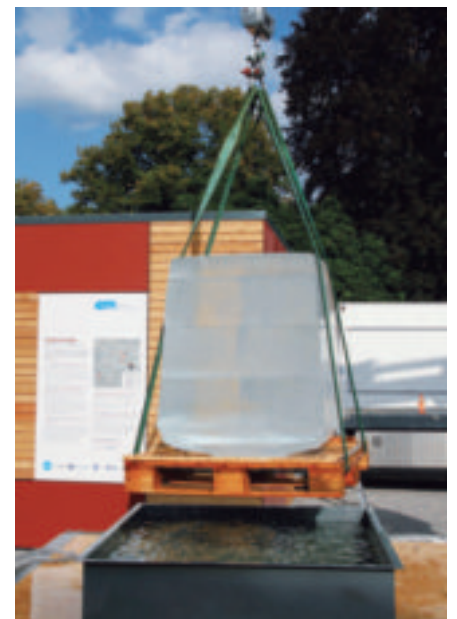
Die so genannte Eisblockwette (siehe Lauftext) zeigte: Fast die Hälfte des tonnenschweren Eisblocks blieb nach drei Wochen im wärmegeprägten Minergie-P-Häuschen noch übrig. In einem dem 70er-Jahre-Standard entsprechenden Häuschen dagegen war das Eis nach drei Wochen restlos geschmolzen.
