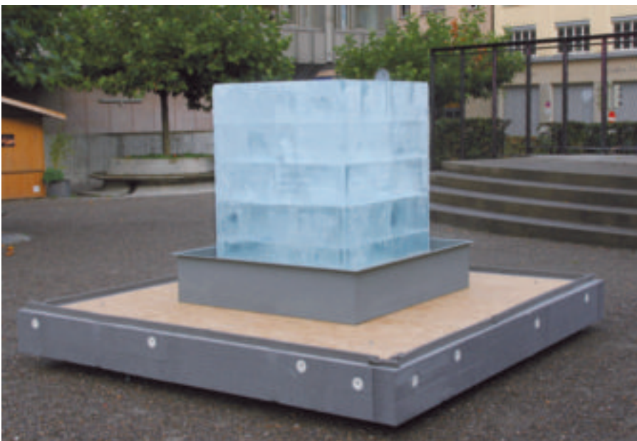
Die so genannte Eisblockwette (siehe Lauftext) zeigte: Fast die Hälfte des tonnenschweren Eisblocks blieb nach drei Wochen im wärmegeprägten Minergie-P-Häuschen noch übrig. In einem dem 70er-Jahre-Standard entsprechenden Häuschen dagegen war das Eis nach drei Wochen restlos geschmolzen.
