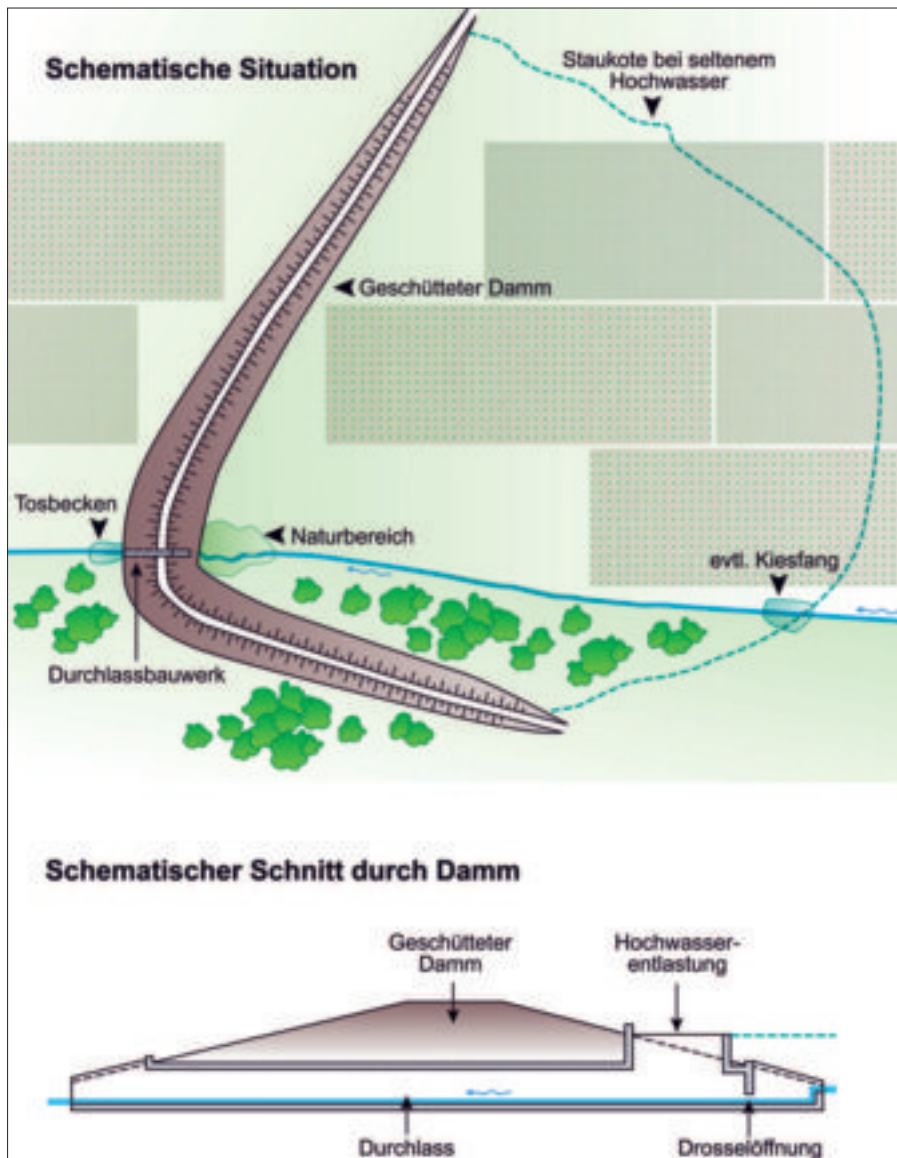
Ein typisches Hochwasserrückhaltebecken: Situation und Schnitt.
