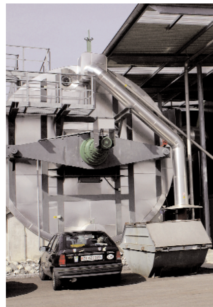
Wird das Grüngut in grossen Tanks vergoren – wie hier im Vergärwerk Oetwil –, so kann neben Kompost auch der Energieträger Gas gewonnen werden.
