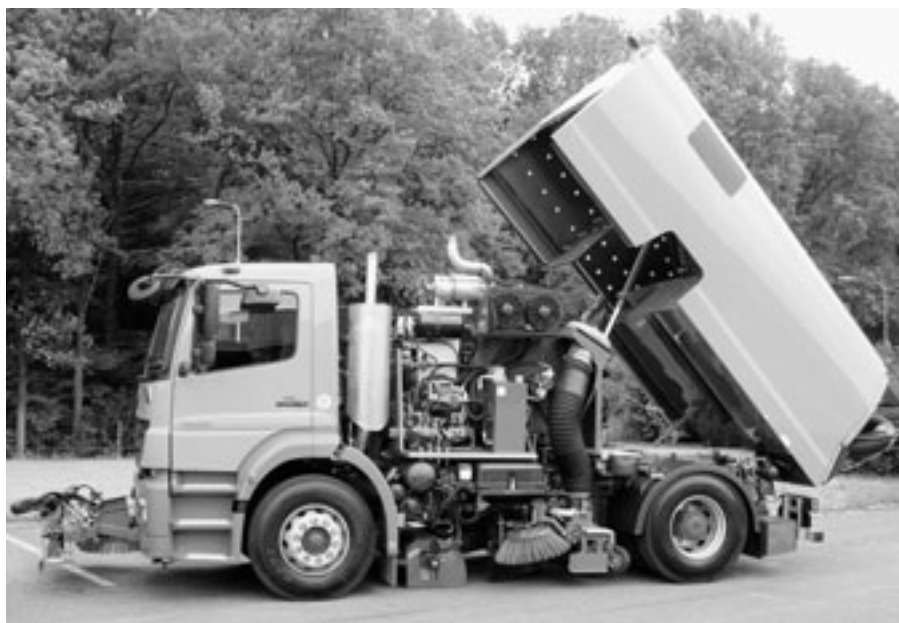
Bei dieser Grosskehrmaschine des Tiefbauamtes sind sowohl Fahr- als auch Aufbaumotor mit je einem Partikelfilter ausgerüstet.
