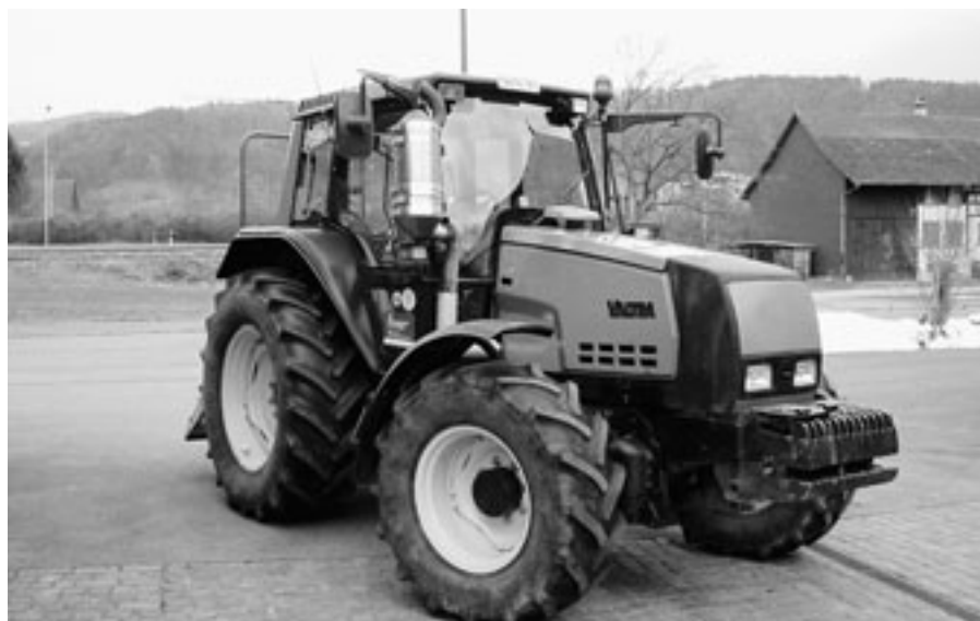
Für Traktoren wären noch deutlich kleinere Filter erwünscht, als sie derzeit am Markt angeboten werden, da trotz sorgfältigem Einbau, die Sicht seitwärts nach vorne etwas behindert ist.
