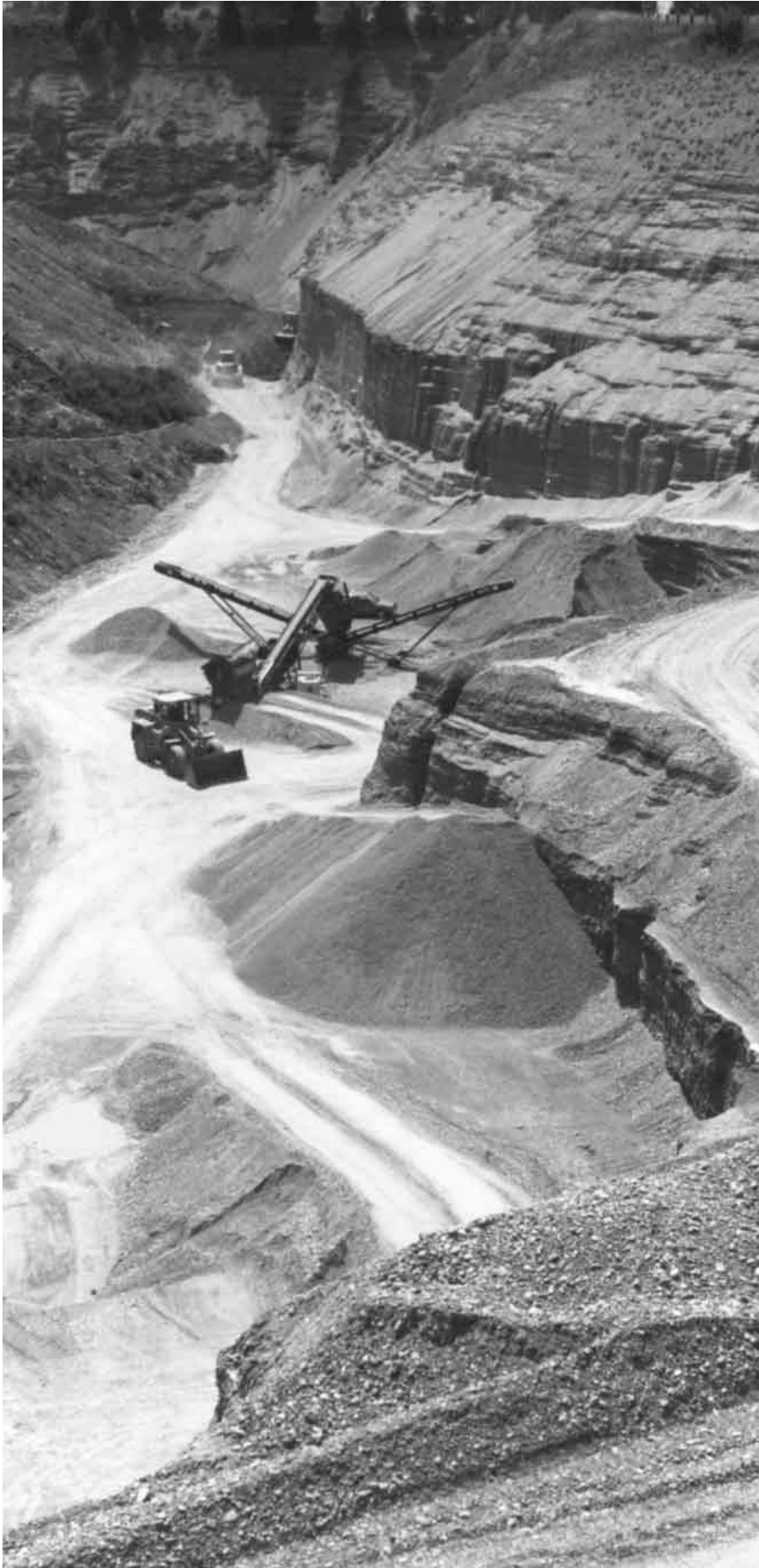
Vorne wird abgebaut, hinten bereits wieder aufgefüllt. Je kürzer ein Abbau betrieben wird, desto weniger gefährdet er das Grundwasser (Windlacherfeld, Buechhölzli, Gemeinde Glattfelden). Quelle: AWEL/AW
