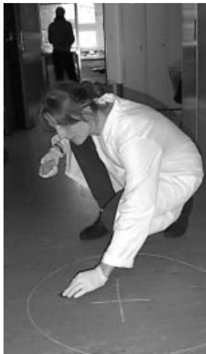
Inaktivierungsnachweis: Im Korridor eines Laboratoriums der Universität Zürich wird der Erfolg einer Inaktivierungsmassnahme nach einem Zwischenfall überprüft. Dazu wurden testweise einige Milliliter einer Nährlösung verschüttet, die gentechnisch veränderte Escherichia coli -Bakterien enthielt. Zur Inaktivierung wurde die kontaminierte Fläche anschliessend mit 70-prozentigem Alkohol behandelt.
