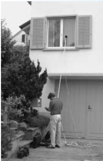
Abb. 1: Lärmmessung am «offenen Fenster». In der Praxis wird der Schallpegel aber am geschlossenen Fenster gemessen und wegen Reflexionen korrigiert. Dies ist messtechnisch einfacher und die Werte sind vergleichbar.
