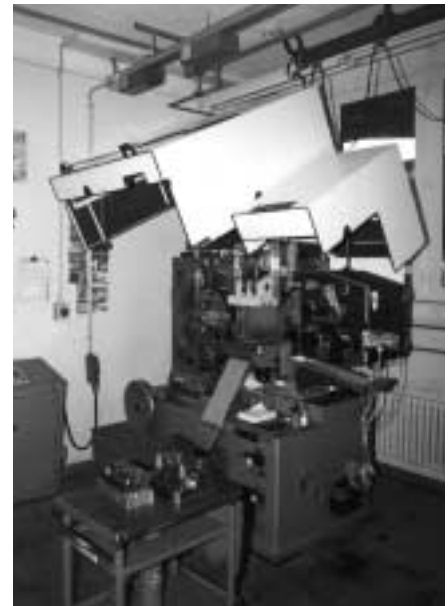
Abb. 2: SONO – Kompaktabsorber in der Stanzerei bei der Firma Madag AG. (Foto: Suva)
