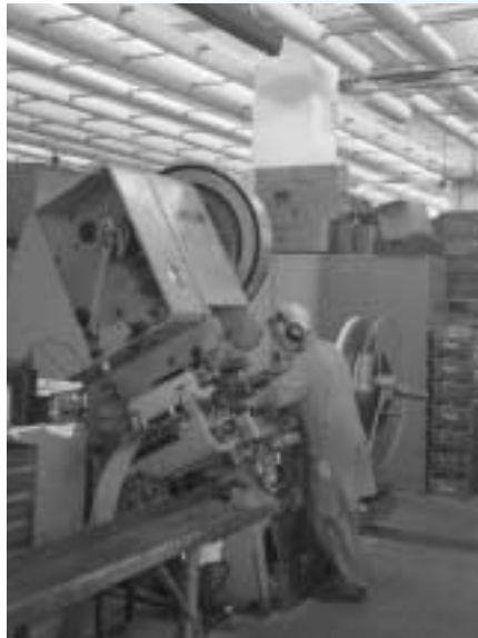
Abb. 1: Ausschwenkbare Kapselung an einem sehr lärmigen Stanzautomaten (Foto:
