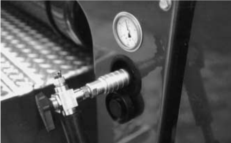
«Biogas-Tanken» ist einfach: Der Gasfüllstutzen wird auf den Einlass geklemmt – schon strömt der CO 2 -neutrale Treibstoff in den crashtsicheren Gasdruckbehälter.
