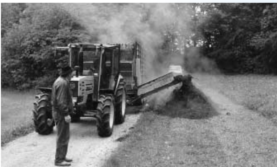
Die Mieten können bei der Feldrandkompostierung mit dem auf Landwirtschaftsbetrieben häufig schon vorhandenen Seitenstreuer optimal aufgesetzt werden.
