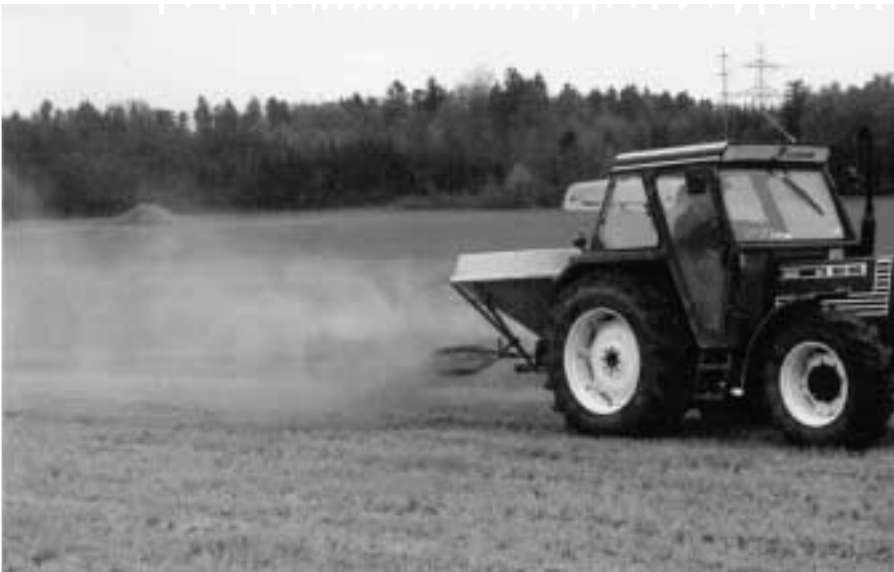
...während für getrockneten Klärschlamm ein Düngerstreuer genügt.
