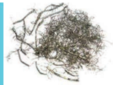
Kein Abfall: Gummimehl und Metallfraktion in Reinform.
