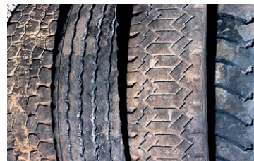
Reifen mit weniger als 1,6 mm Profiltiefe, Schäden und unregelmässigen Abriebspuren gelten als Abfall.
