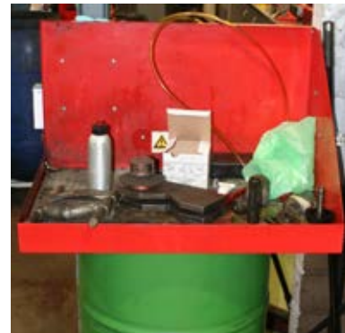
Kleinteilereiniger: Klappdeckel, die bei Nichtbetrieb geschlossen werden.
