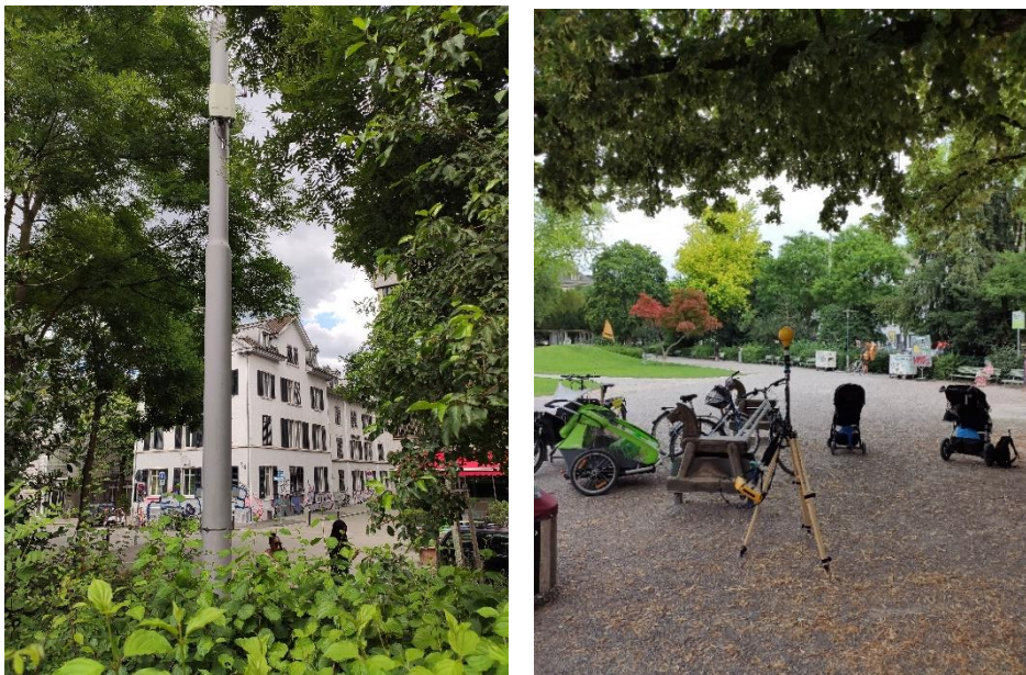
Abbildung 2: Sendeanlage auf rund 6 Metern Höhe über Grund in der Bäckieranlage, 8004 Zürich (links) und Narda-Messsystem (SRM 3006 mit dreifussiger Universalantenne 27 MHz – 6 GHz) am Messpunkt 3 beim Spielplatz vor dem Quartierzentrum in rund 30 m Distanz zur Antenne (rechts).
