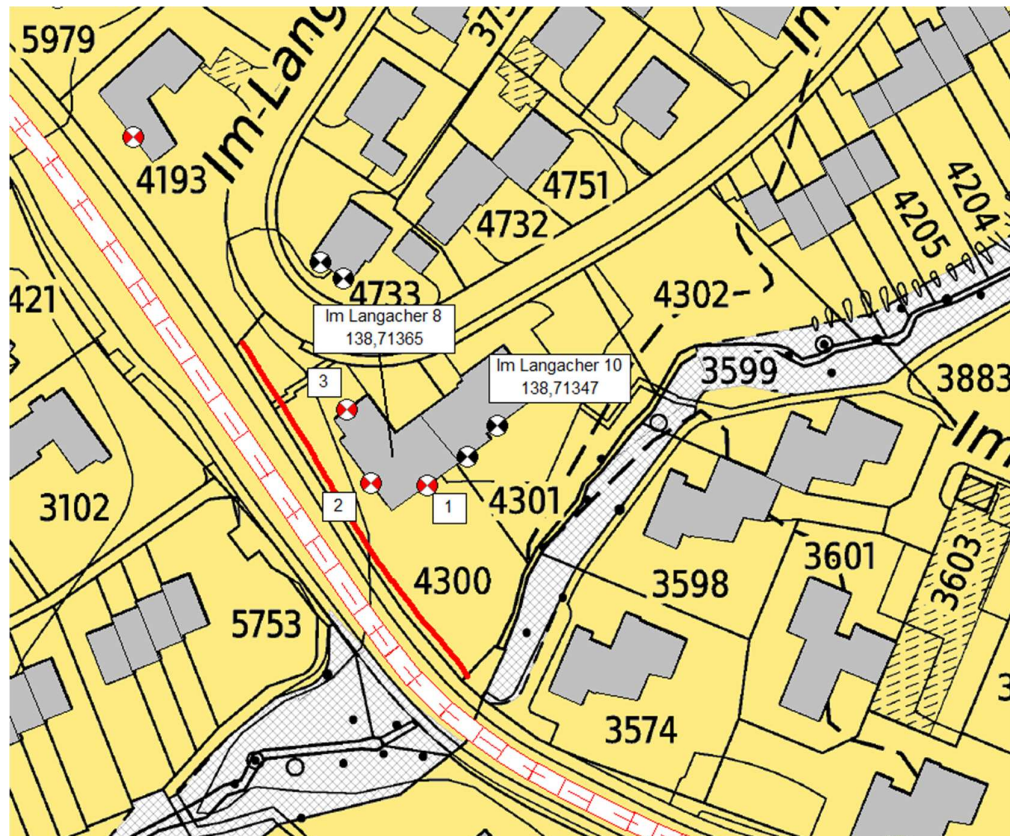
Abb 4 Richterswil, Abschnitt 24 , vorgeschlagene LSW (Höhe = 2.5 m über Str.niveau, Länge = 78 m)
