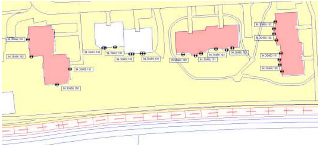
Abb 6 Abschnitt 3: Gebäude mit IGW-Überschreitungen (rot markiert)
