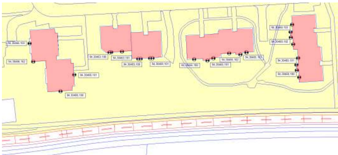
Abb 3 Otelfingen, Abschnitt 3, untersuchte Wohnzone mit Immissionspunkten (gelbe Fläche: ES II). Rot markiert sind Gebäude mit IGW-Überschreitungen im Referenzzustand.
