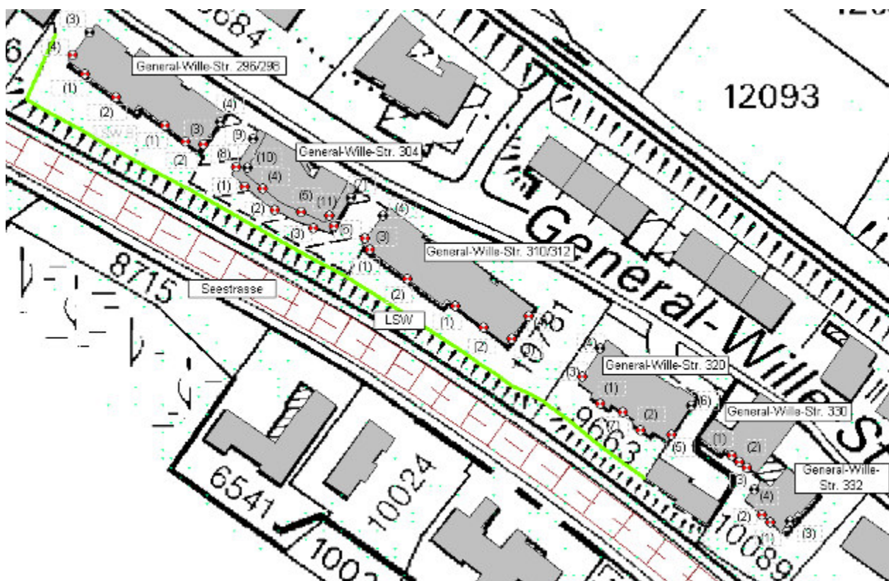
Abbildung 3.4 LSW A (grün) mit 1.7 m Höhe ab Boden auf 179 m Länge für die Liegenschaften General-Wille Strasse 296 bis 320 im Abschnitt 19, Meilen.
