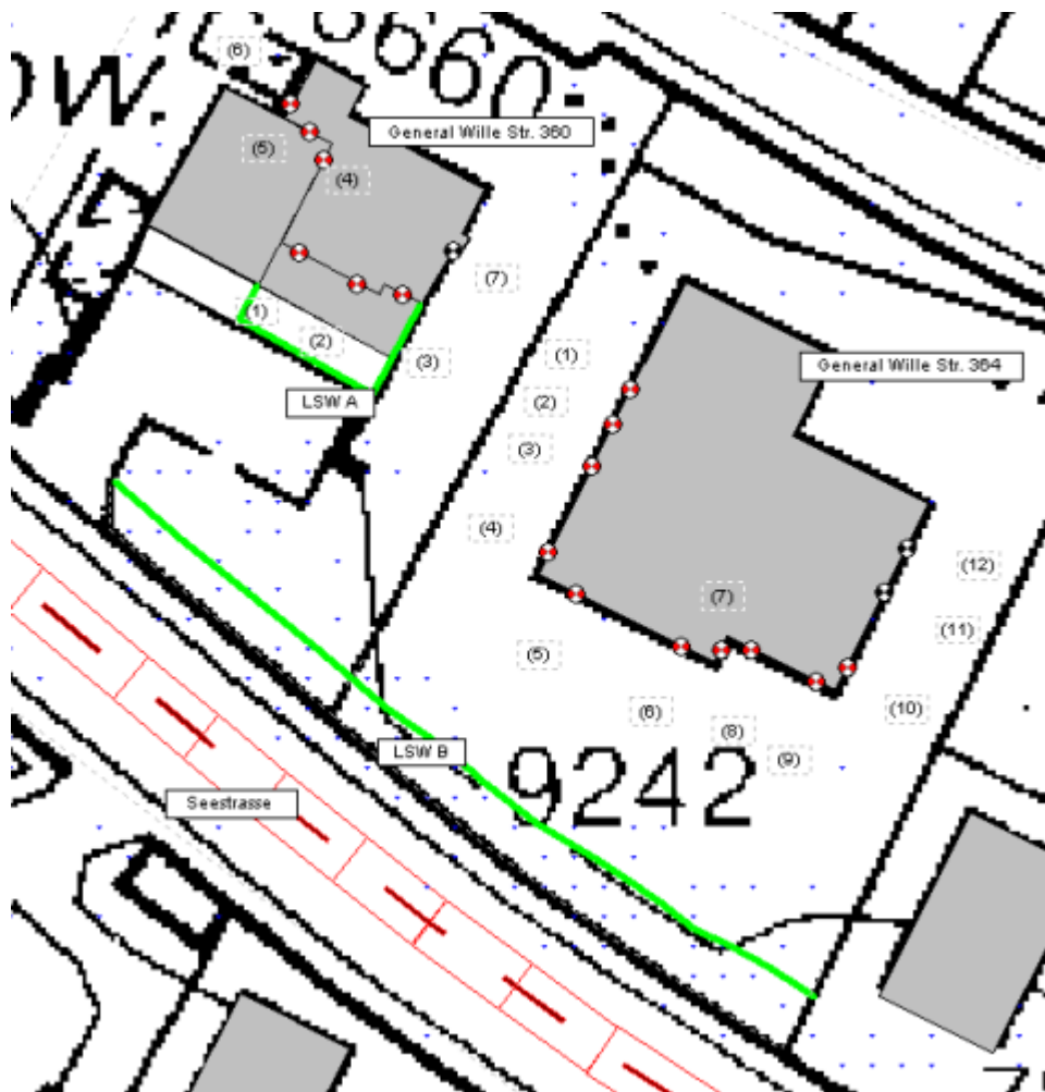
Abbildung 2.1 Abschnitt 22, Immissionspunkte und vorgeschlagene LSW. Rot markiert sind Empfangspunkte mit IGW-Überschreitungen im Zustand 2029 mit Massnahmen.
