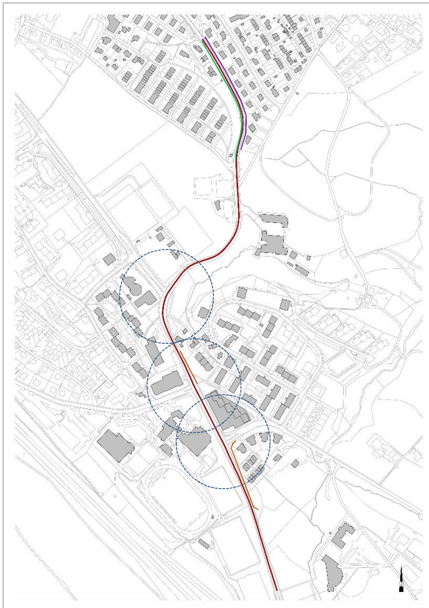
Abb 2 Situation Zugerstrasse Horgen, Projektperimeter Str.-Nr. 314, km 1.485 – km 2.812 rote Linie: Projektperimeter "Strassenbau-Projekt" (km 1.485 - km 2.812), lila Linie: Lärmschutzwand projektiert, orange Linie: Lärmschutzwand bestehend grüne Linie: Abschnitt "lärmarmer Belag" (km 2.536 - km 2.812), blau gestr. Linie: Perimeter "Lichtsig- nalanlage"
