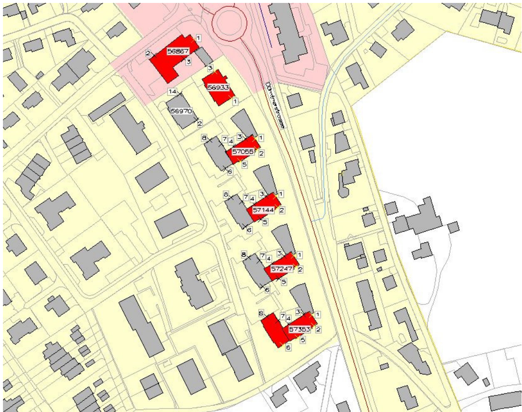
Abb 3 Situation mit Immissionspunkten (gelb: ES II, hellrot: ES III). Rot markiert sind Gebäude mit IGW-Überschreitungen im Sanierungshorizont (2036 ohne Massnahmen).
