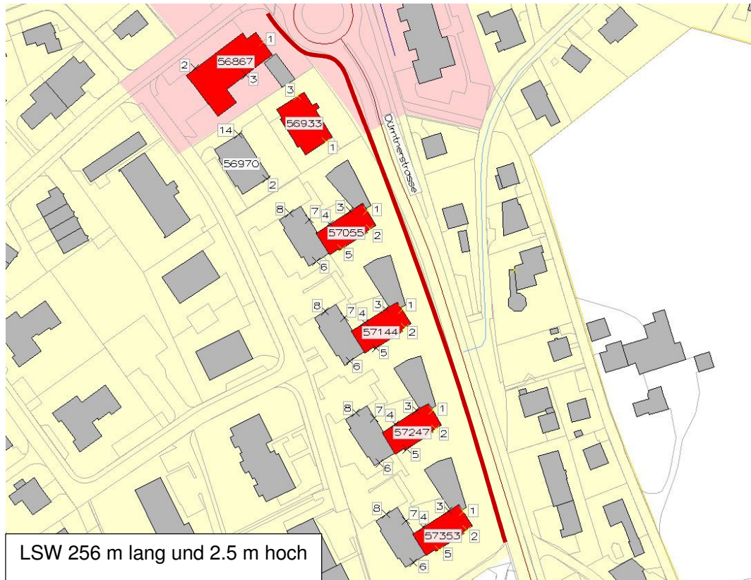
Abb 4 Abschnitt 24, Immissionspunkte und untersuchte LSW (rote Linie: Höhe = 2.5 m, Länge = 256.0 m) (gelbe Fläche: ES II, hellrote Fläche: ES III). Rot markiert sind Gebäude mit IGW-Überschreitungen im Zustand 2036 mit Massnahmen
