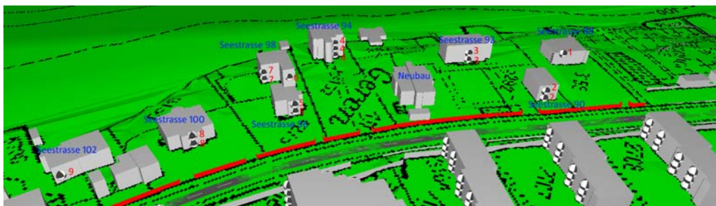
Bild 5: Abschnitt 17, Erlenbach, 3D Visualisierung der untersuchten LSW (rot eingefärbt) mit einer Wandhöhe von 2.0 m und einer gesamten Länge von 192 m.
