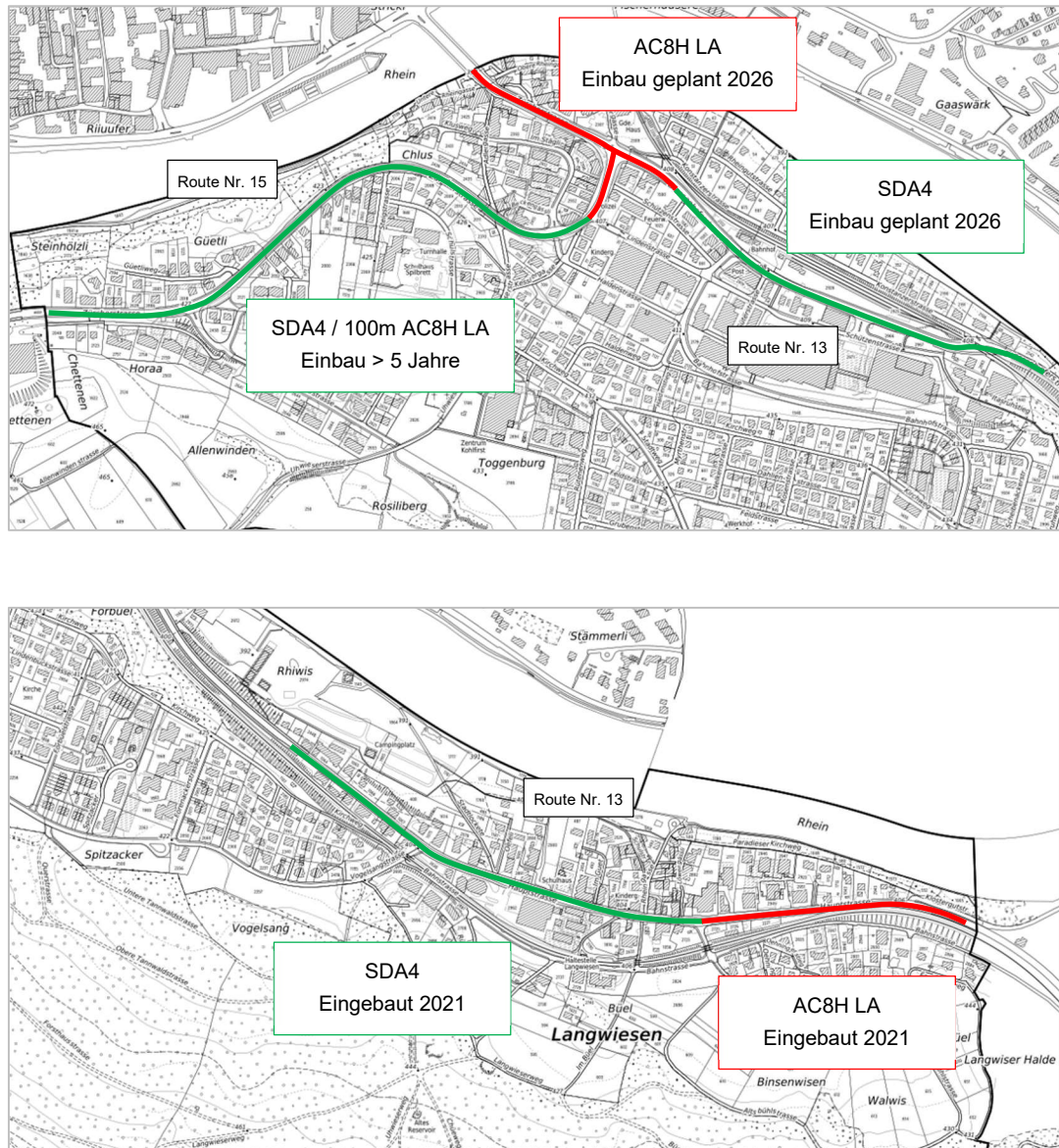
Abb. 2 Perimeter lärmarmen Belag: Perimeter "AC 8H" und "SDA 4" der zukünftig realisierten Massnahme.
