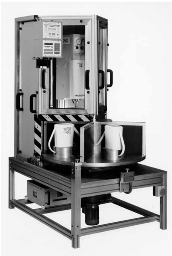
Bild 36 Verschaltung an einer Ultraschallschweißmaschine mit einem Drehtisch.
