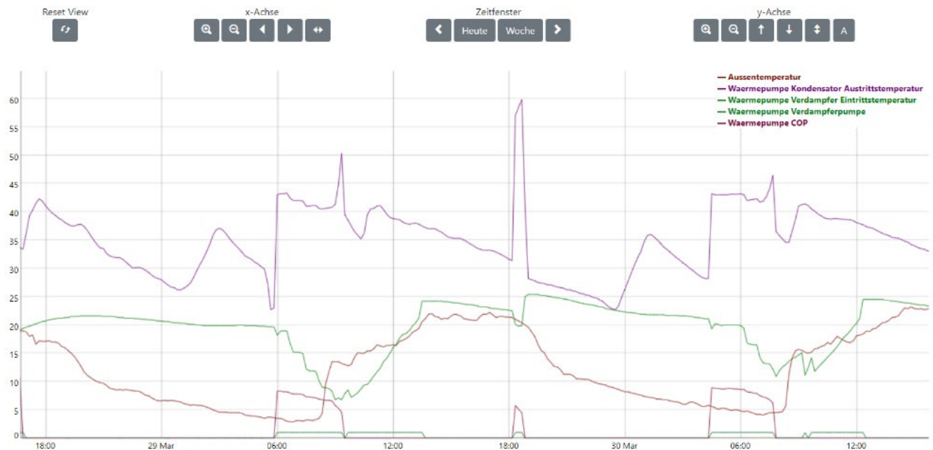
Abbildung 24 Tagesverlauf des Wärmepumpenbetriebs am 29. März 2021 (Screenshot). Die tiefsten COP von rund 5 (dunkelrote Linie) sind während der Aufladung des Brauchwarmwasserspeichers (siehe Kondensator Austrittstemperatur: oberste, violette Linie) nach 18:00 Uhr zu beobachten. Bei der Erwärmung der Heizungsspeicher liegen die COP zwischen 9 und 6. Sie hängen stark von der Vorlauftemperatur (Verdampfer Eintrittstemperatur, grün) ab. Die unterste grüne Linie zeigt die Einschaltphasen der Verdampferpumpe, welche auch den Kreislauf des Solarabsorbers bedient.
